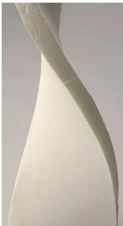
脱落したボード系断熱材
