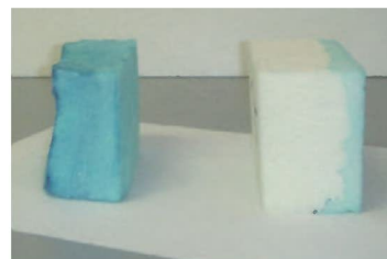
吸水して大きく変形収縮したフォーム（左）
